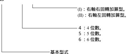
(中型機械式計數器,旋轉歸零型,彈簧拉柄40~45°驅動計數)。
